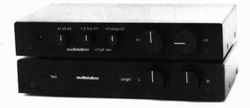
In Verbindung mit dem audiolabor Linearverstärker –schalt–ein–, kann der –fein– zu einem kompletten Vorverstärker erweitert werden.
